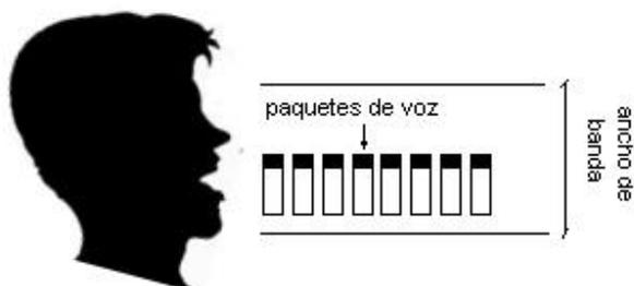
Cada paquete de voz está compuesto de dos partes: **los datos de voz** propiamente dichos (en la figura representada por rectángulos blancos) y el **encabezado** (rectángulos negros) que incluye la señalización o todos los datos de los protocolos usados en la transmisión. Esto ocurre en cada paquete transmitido.
