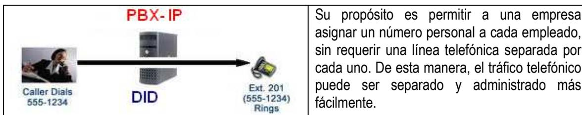
DID requiere que se contrate una línea RDSI (ISDN) o Digital y que se pida a la compañía telefónica que asigne un rango de números. Luego se necesita en sus instalaciones el equipo respectivo, el cual consiste de tarjetas **BRI, E1** o **T1** o pasarelas.
