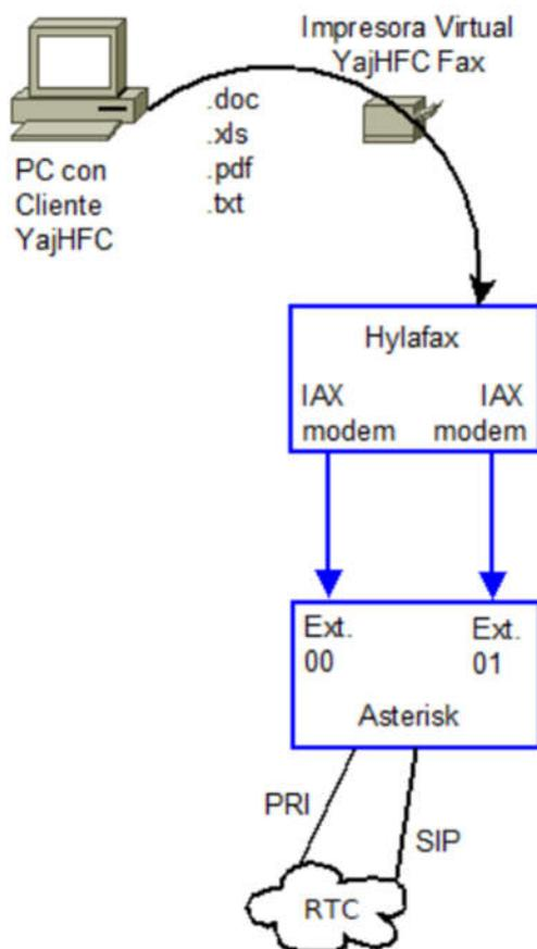
Para que el sistema funcione con **VIVAit** Call necesitamos que los PC's de usuario tengan instalado el cliente YajHFC. A efectos prácticos existe una nueva impresora que envía el fax al exterior. El servidor Hylafax envía el fax a través de sus extensiones IAX modem, dadas de alta en el sistema **VIVAit** Call utilizan la plantilla para IAX fax.
